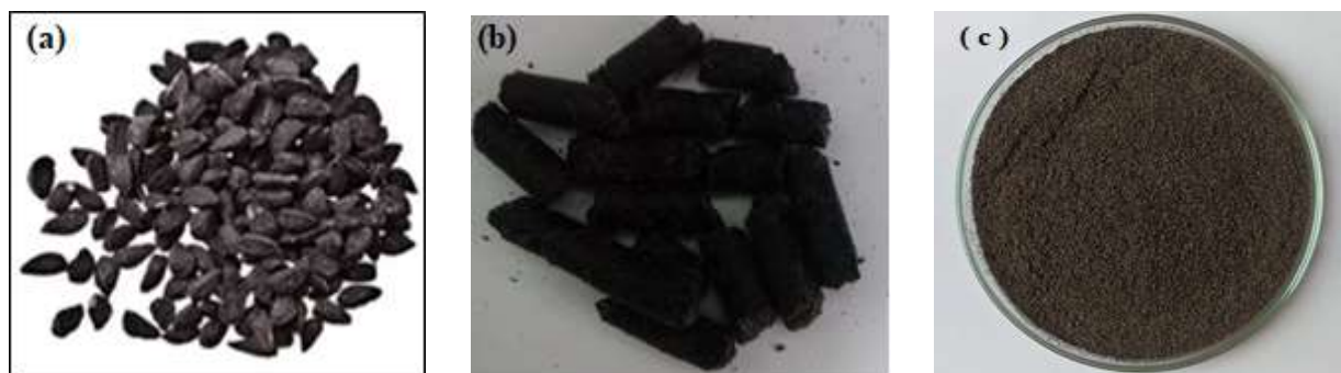
Figure II.2 : Les photos de, (a) les graines noires, (b) déchets des graines de cumin noires récupérés, (c) la poudre des déchets des graines de cumin noires (adsorbant).
