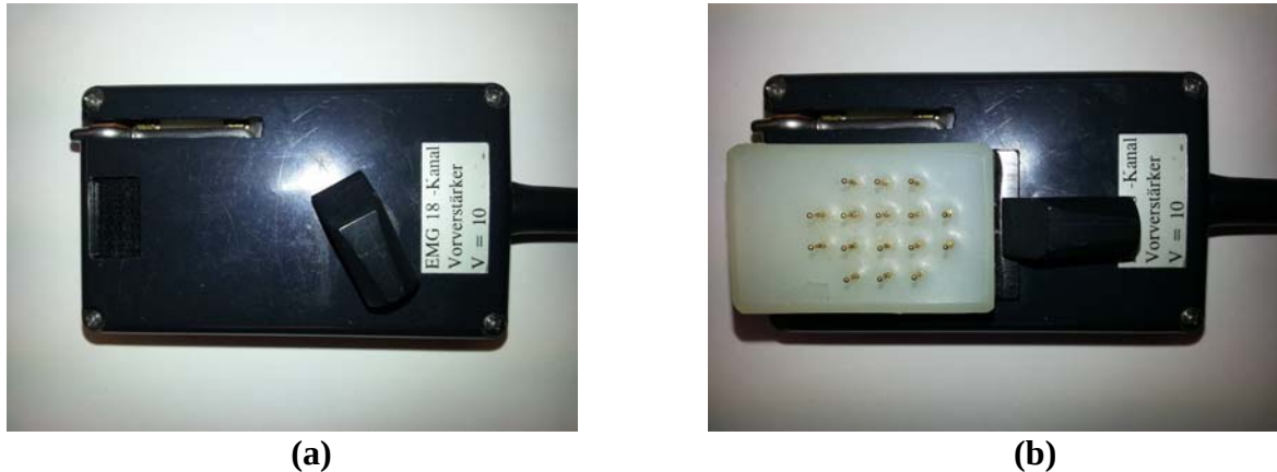
Figure 2.15. Préamplificateur avec un gain de 10. (a) Amplificateur sans électrodes (à vide). (b) Amplificateur chargé d'électrodes.
