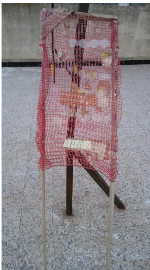
Figure II. 5. Dispositif utilisé pour l'exposition des échantillons de PEBD aux conditions naturelles
