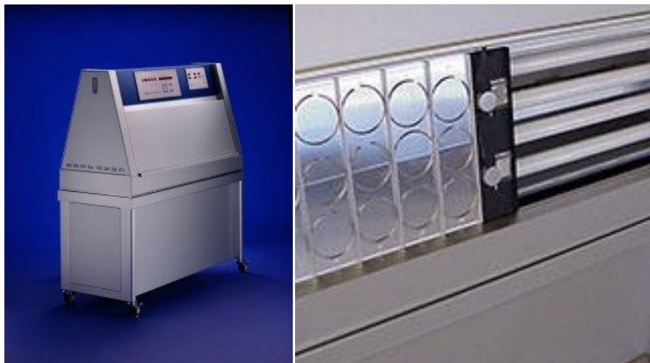
Figure II. 3. Photographie de l'appareil de vieillissement accéléré QUV600
