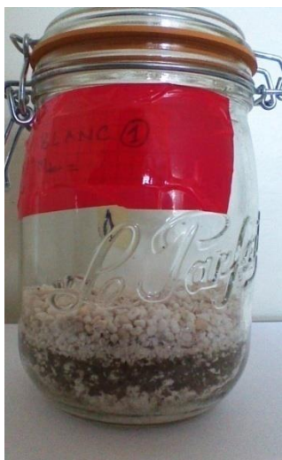
Figure II. 6. Bocal le parfait schématique (droite) et réel (gauche) mis en place pour réaliser des tests de biodégradation en enfouissement
