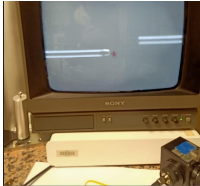
Figure IV 39. Vue de dessus de la microlentille M1 (grand axe) en présence d'un décalage latéral ( x ).
