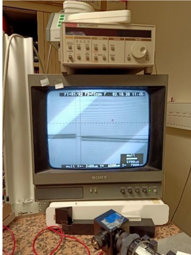
Figure IV 24. Exemple d'un décalage axial et angulaire \theta entre deux fibres.
