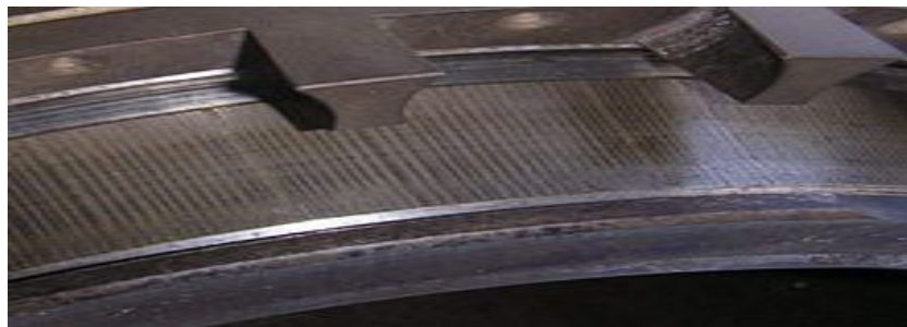
Fig. 1.21. Cannelure sur un roulement [Emer2012].
