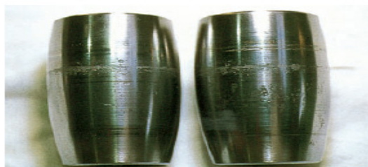
Fig. 1.25. Écaillage superficiel [Emer2012].
