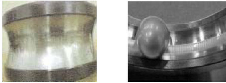
Fig. 1.20. Phénomène de piquetage observé sur une piste de roulement [Emer2012].
