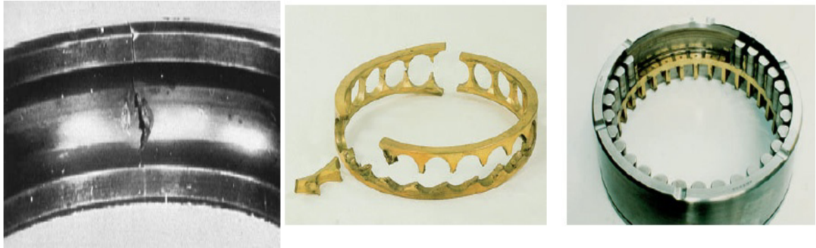
Fig. 1.23. Rupture des éléments d'un roulement [Emer2012].
