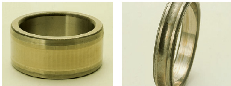
Fig. 1.24. Criques de corrosion sur une piste de roulement [Emer2012].
