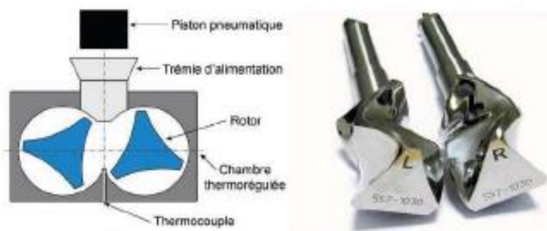
Figure III.5: Schéma du plastographe-PLASTI-CORDER et photo des rotors [Kou13]
