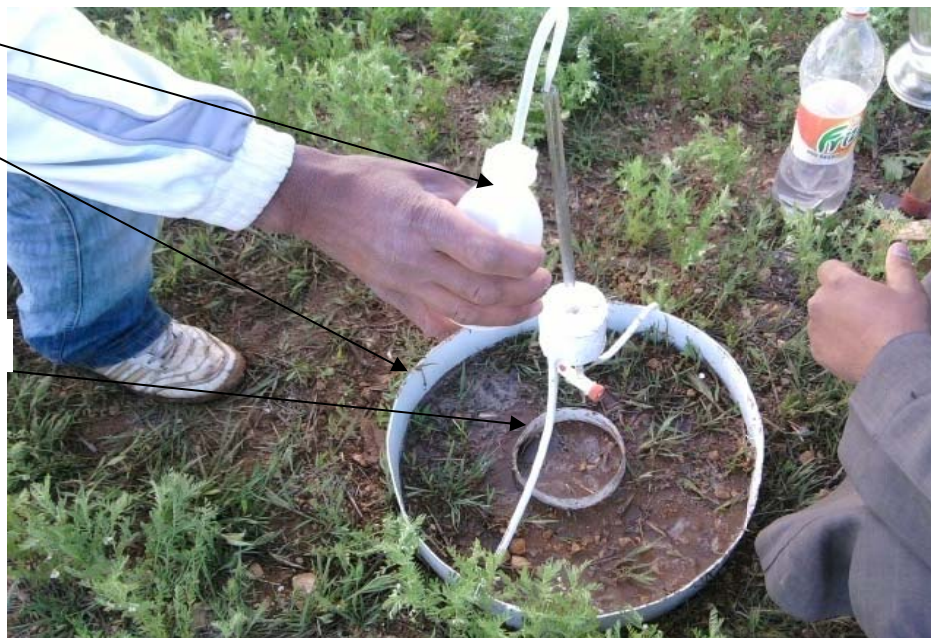
Figure 4 : l'opération de mesure de la vitesse d'infiltration avec l'appareil de Mûntz.
