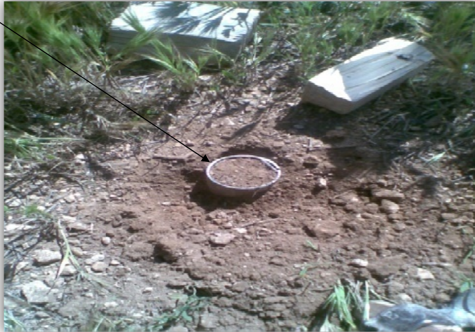
Figure 03. L'opération de prélèvement du sol pour la mesure de la densité apparente par la méthode de cylindre.
