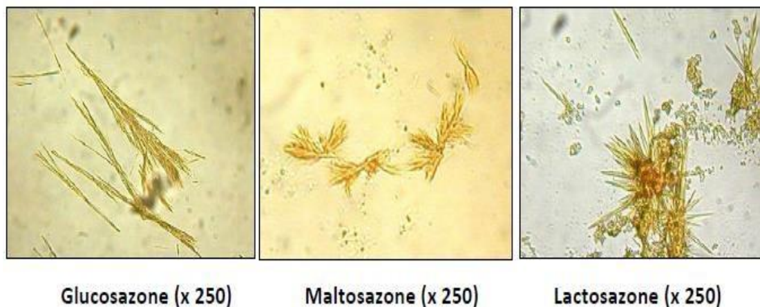
Fig. 35. Les différents cristaux d'oses mélangés avec la phénylhydrazine observés à l'aide d'un microscope.
