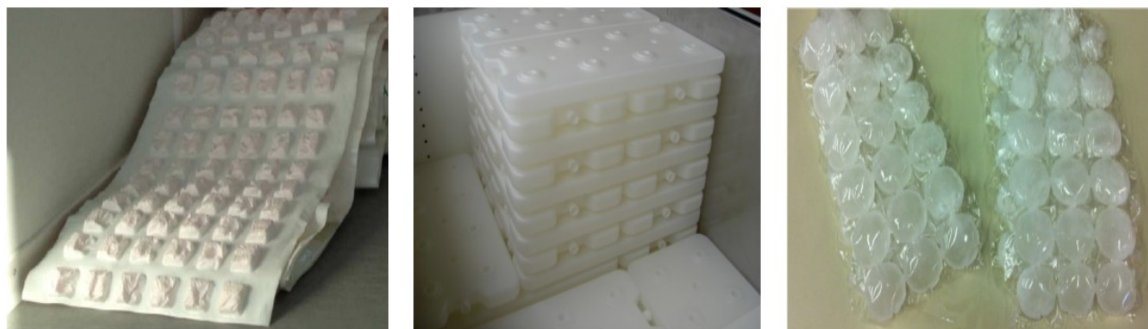
Figure 1.8: Encapsulation des Matériaux à Changement de Phase
