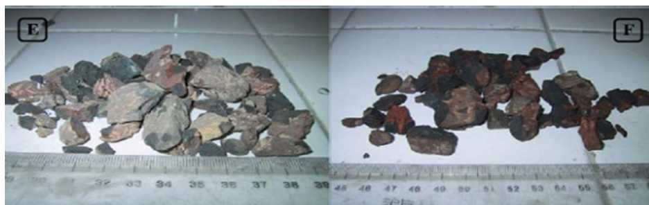
Figure 1.7: Images descriptives des agrégats, sur la gauche des agrégats simples, à droite des agrégats qui ont absorbé les MCPs
