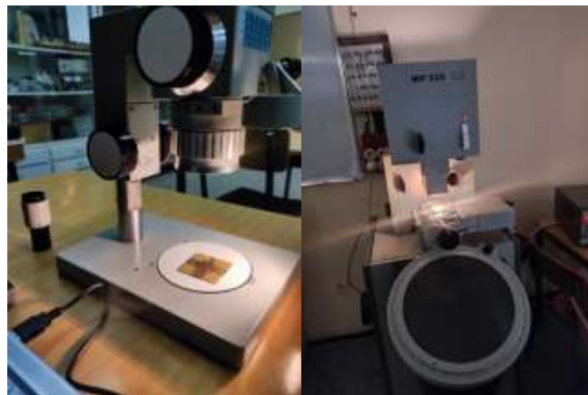
Figure II.11 Inspection de la structure sous microscope et projecteur de profil.
