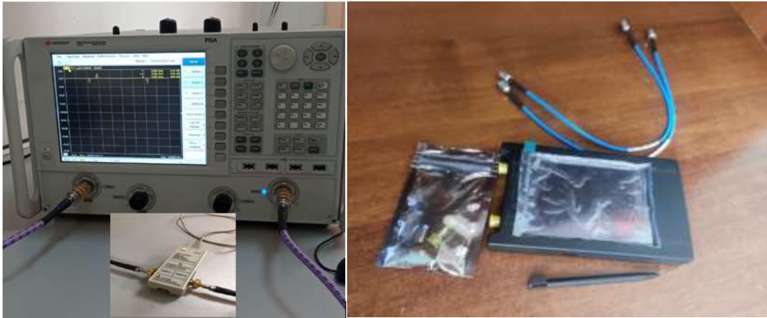
Figure 1.23 Procédure de calibration effectuée sur deux types d'analyseurs de réseau vectoriel (VNA).
