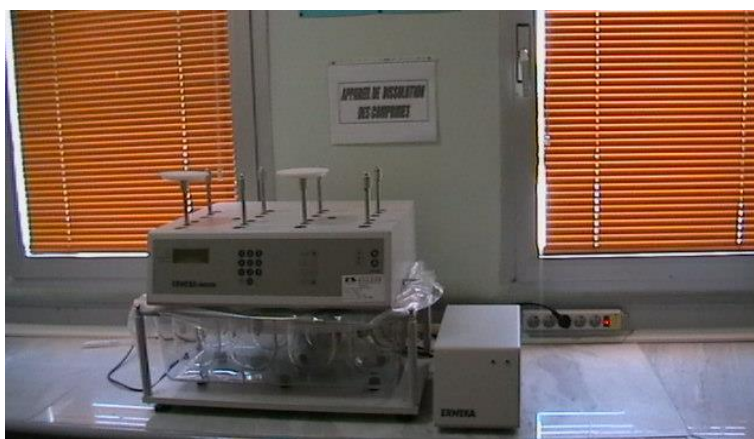
Annexe.6 : appareil de dissolution des comprimés.
