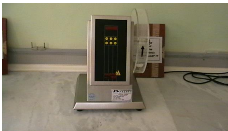
Annexe.3 : appareil de détermination de la friabilité des comprimés.
