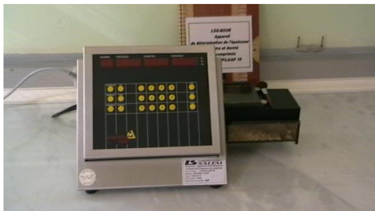
Annexe.2 : appareil de détermination de la dureté des comprimés.
