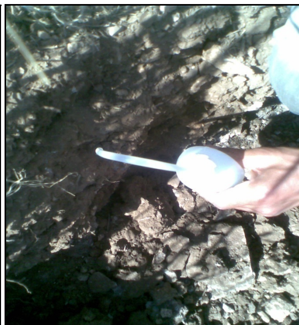
Test de présence des éléments Calcimagnésiques.
