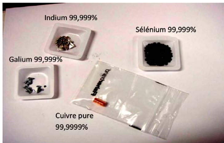
Figure 1 : Eléments chimiques purs utilisés pour la synthèse du matériau massif \text{CuIn}_{0.7}\text{Ga}_{0.3}\text{Se}_2
