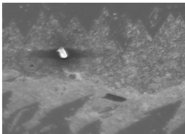
Figure 9 : Image MEB d'une surface de lingot du matériau massif \text{CuIn}_{0.7}\text{Ga}_{0.3}\text{Se}_2 .
