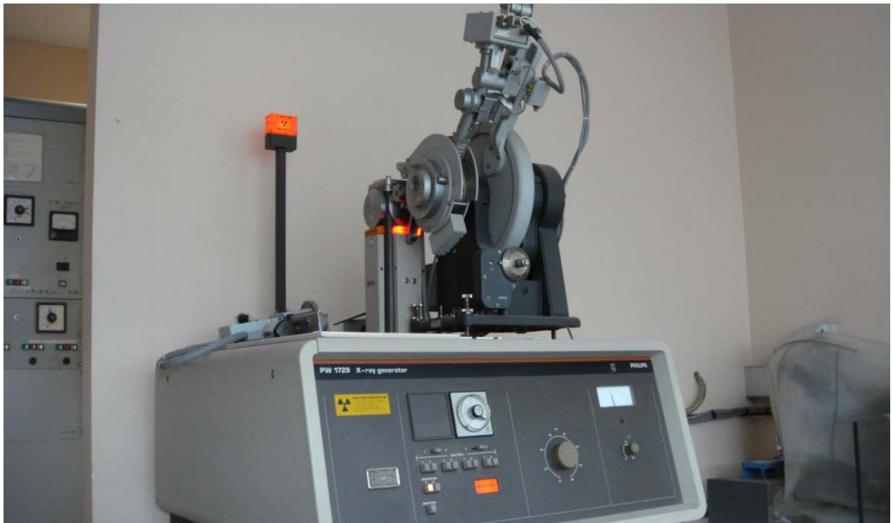
Figure 14 : Dispositif de diffraction de rayon X utilisé (Université de Perpignan).
