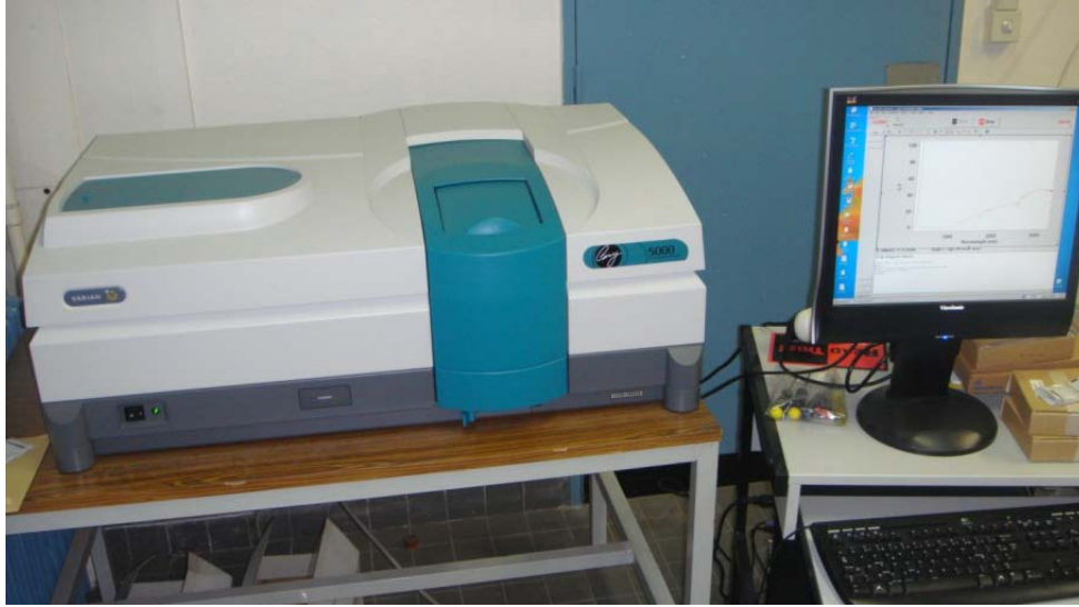
Figure 38 : Spectrophotomètre utilisé pour les mesures de transmission des couches minces de CIGS (INSA de Toulouse).
