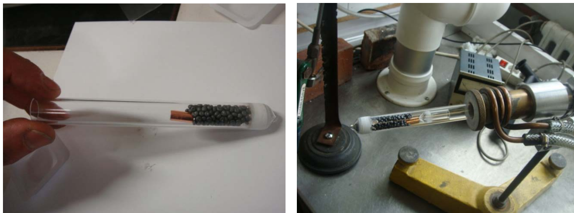
Figure 2 : Introduction des éléments chimiques purs dans un tube à quartz.
