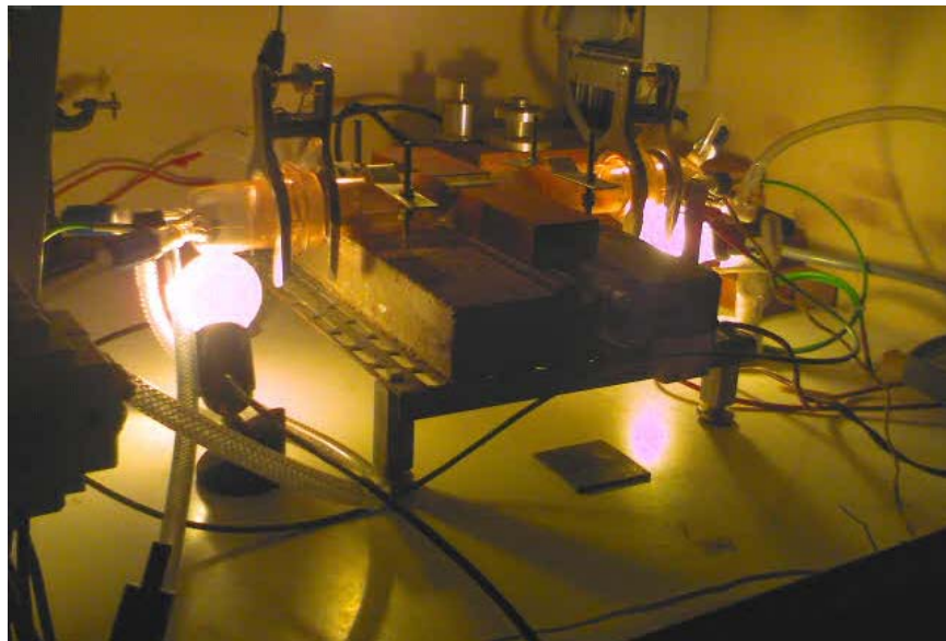
Figure 5 : Photographie de la technique CSVT en cours de dépôt (Laboratoire CNRS-PROMES-Perpignan).
