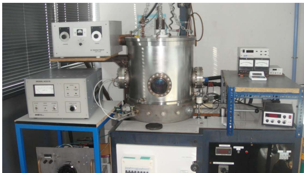
Figure 13 : Dispositif expérimental du pulvérisateur cathodique utilisé au laboratoire CNRS-PROMES de Perpignan-France.
