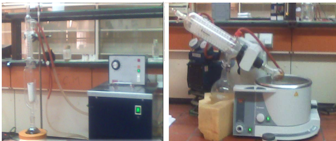
Figure 26 : Extraction des huiles de pulpe d'olive par Soxhlet (A gauche) et Evaporation sous vide par rotavapor de type Heidolph (A droite).
