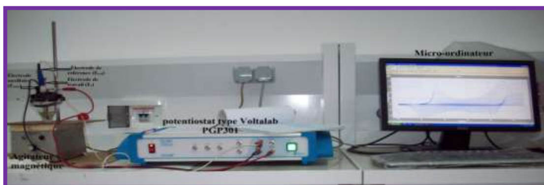
Figure II-3: Représentation schématique du montage utilisé en voltampérométrie cyclique et en (SIE) pour les mesures d'impédance.
