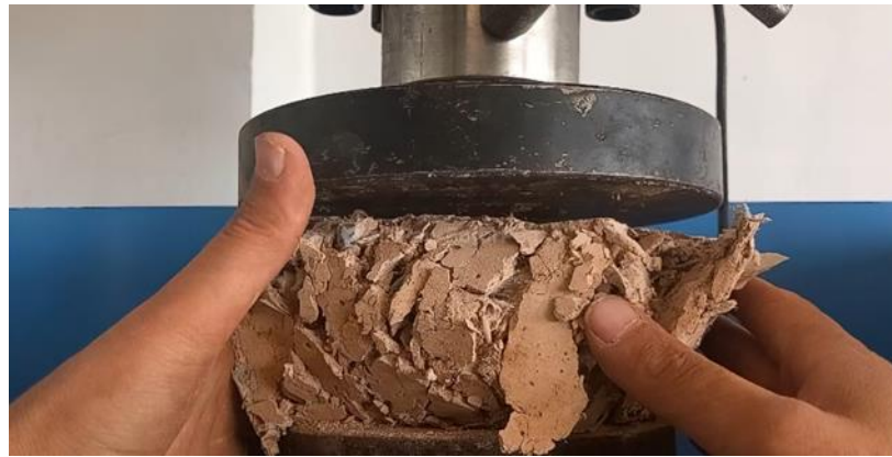
Figure IV.11. Effet de la coupe FM sur la cohésion de la brique de terre
