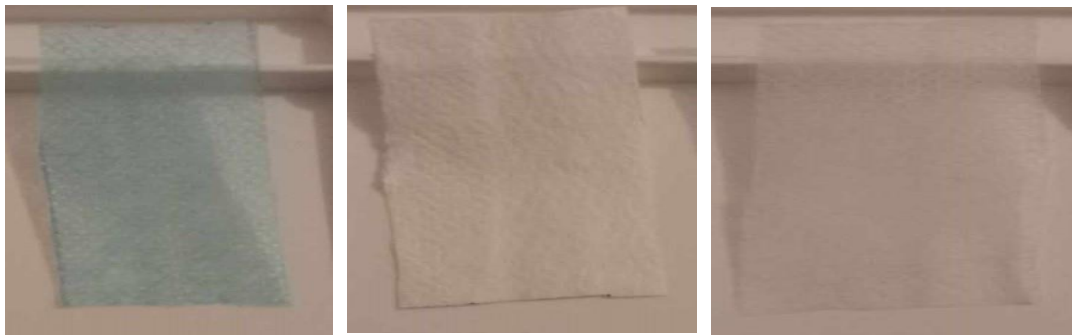
Figure IV. 1 Les trois couches d'un masque facial
