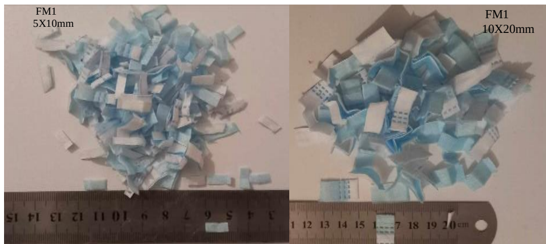
Figure IV.2 Dimensions des pièces de masques chirurgicaux considérées dans cette étude : (a) MiS et (b) MiL .
