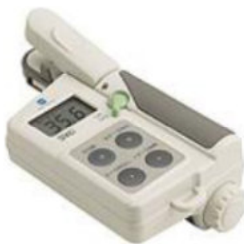
Figure II.3. Appareil de mesure de chlorophylle de model : SPAD – 501
