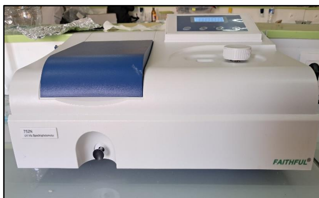
Figure III.18 : Spectrophotomètre UV-visible utilisé pour la mesure des absorbances.
