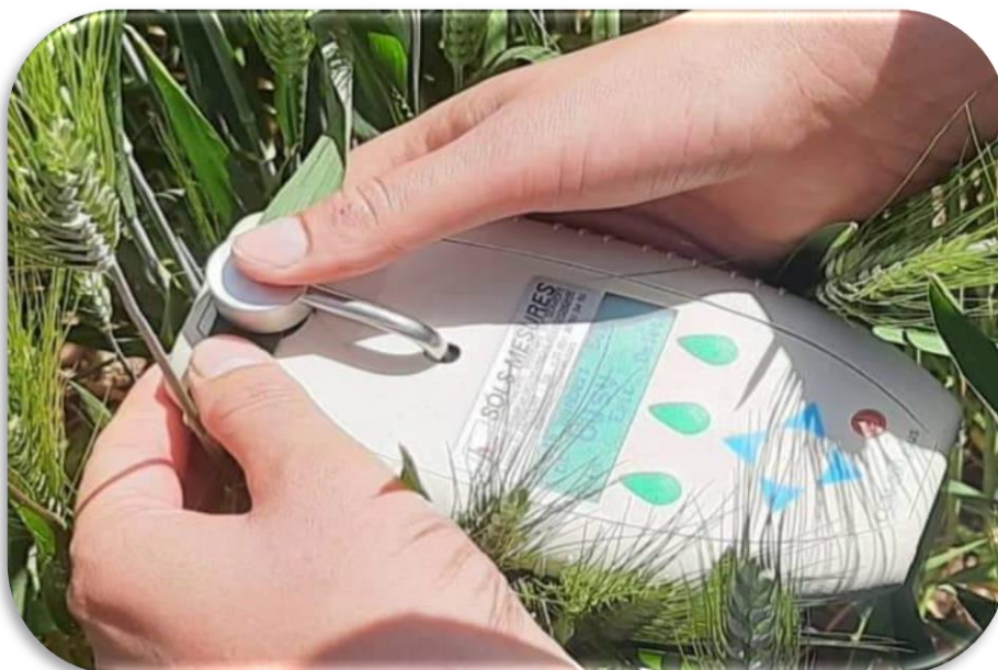
Figure 5. Le mesure de la teneur en chlorophylle à l'aide d'un appareil CCM-200 plus.
