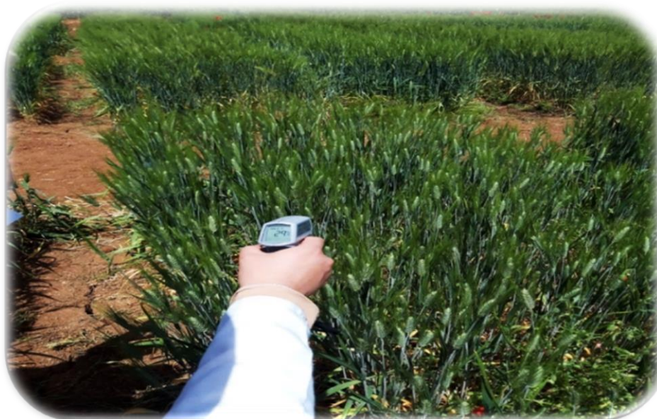
Figure 6. Le mesure de la température à l'aide d'un thermomètre infrarouge portable (Fluke Corporation. Everett.WA. USA).
