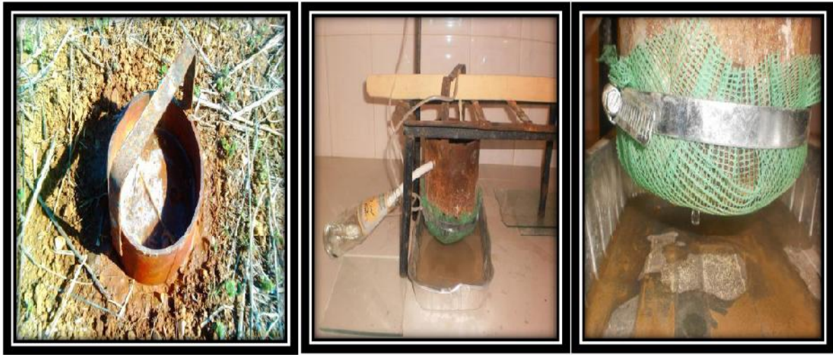
Photo 3. Mesure de la perméabilité du sol au laboratoire après saturation.
