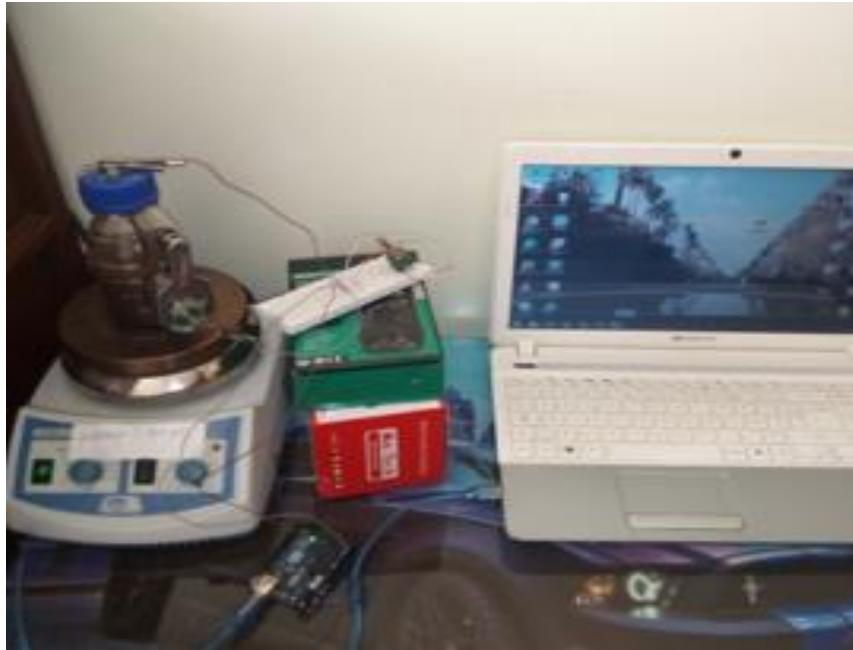
Figure II.7. Montage de la PACM
