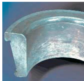
Figure 1.15 - Corrosion de contact sur l'alésage et la face d'appui
