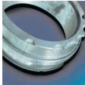
Figure 1.14 - Ruptures dues à un montage avec coups
