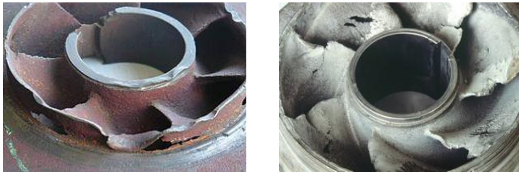
Figure 1.21 - Dommages causés par la cavitation sur une pompe centrifuge
