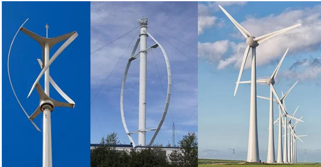
Figure 1.3. éolienne a axe vertical Vs éolienne a axe horizontale
