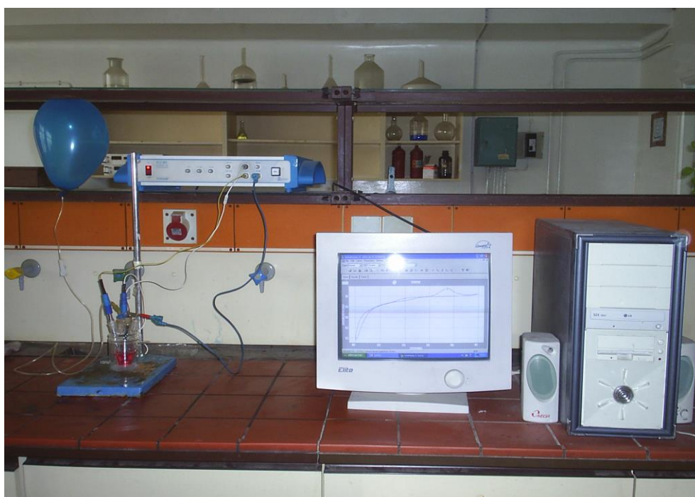
Figure 2.1: dispositif expérimental (la cellule et le voltalab 40)
