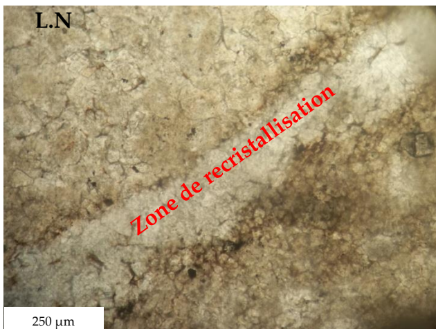
Photo. III.17. Lame montrant le remplissage en minéraux secondaires (Les zones de recristallisation)
