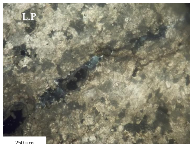
Photo. III.19. Lame montrant le filonnets du quartz en L.N (à gauche) et en L.P (à droite).
