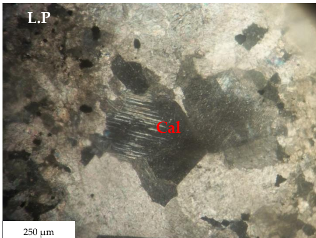
Photo. III.16. Lame montrant les cristaux primaires du calcite où le clivage est notable
