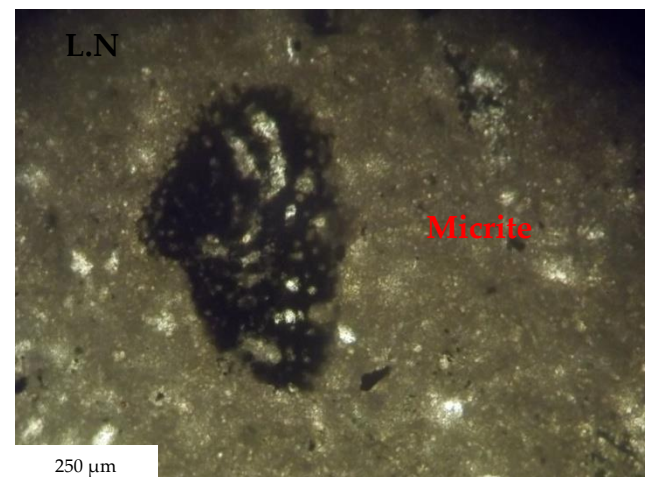
Photo. III.26. Lame montrant un fragment du lamellibranche (à gauche) et une section de foraminifère (à droite) en L.N dans un liant micritique.
