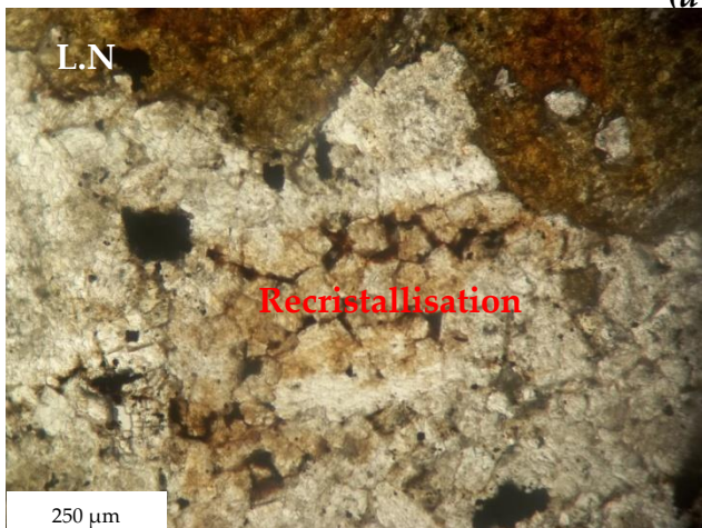
Photo. III.22. Lame montrant la zone de la recristallisation en L.N (à gauche) et en L.P (à droite).
