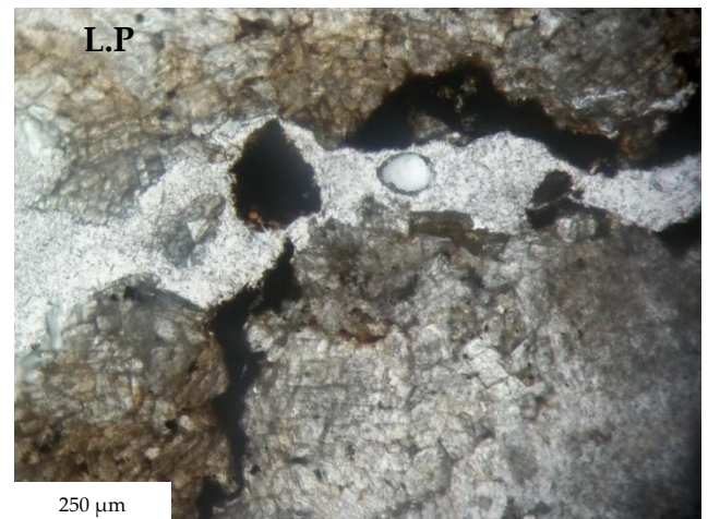
Photo. III.24. Lame montrant la silicification avec l'inclusion des oxydes (la minéralisation) en L.N (à gauche) et en L.P (à droite).
