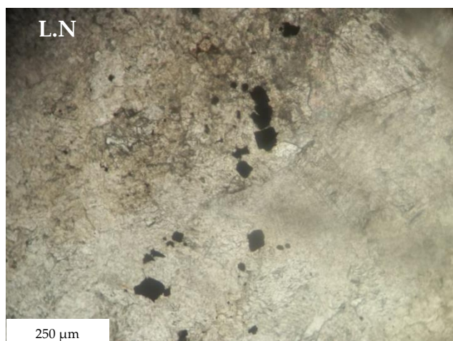
Photo. III.18. Lame montrant les grains de pyrite automorphe et sub-automorphe en L.N (à gauche) et en L.P (à droite).
