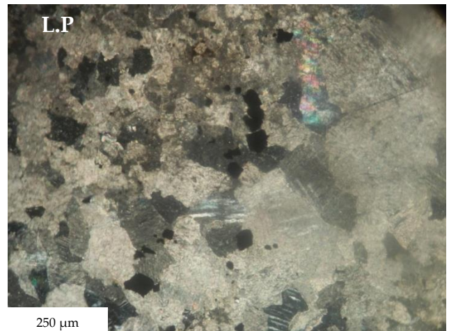
Photo. III.16. Lame montrant les cristaux primaires du calcite où le clivage est notable
